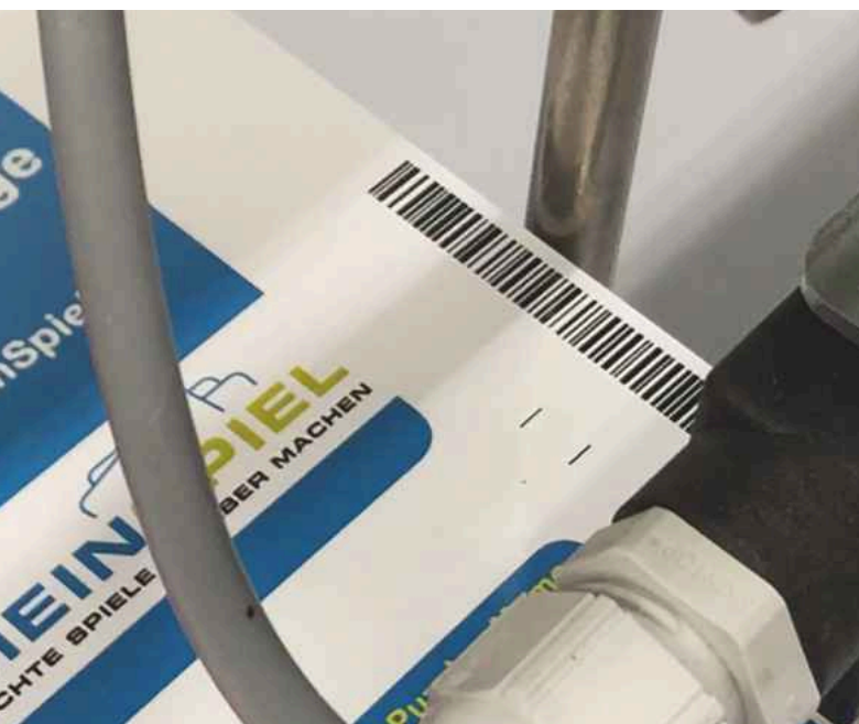
Die Verarbeitung der Spiele ist automatisiert. Identifiziert werden sie durch Scancodes.
