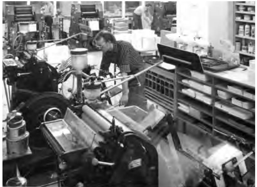
Die Tiegeldruckpresse. Entwickelt im 19. Jahrhundert für den Buchdruck, heute gern noch zum Stanzen im Einsatz.
